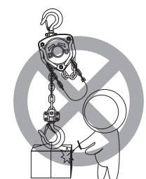
⑥ 勿在悬吊的重物上面实施焊接或切割操作
