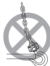
④ 勿将重物直接挂于吊钩尖端上支承
