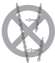
① 勿使用带有变形或有裂痕的起重链条的葫芦
