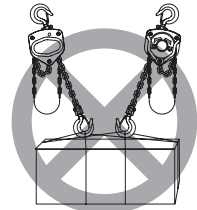
③ 勿使用几台同时起吊超出一台葫芦额定载荷的重物
